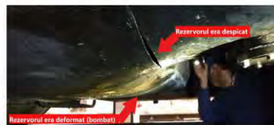
Imaginea 6 – rezervorul de motorină despicat și deformat de o explozie în interiorul acestuia
