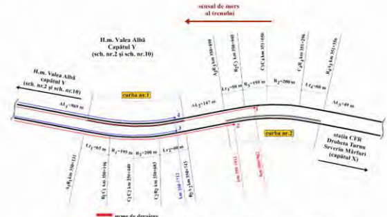
Desen nr. 4 - urmele lăsate de materialul rulant care a circulat deraiat
