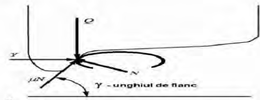
fig. 8. Forțele ce acționează la contactul roată-șină
