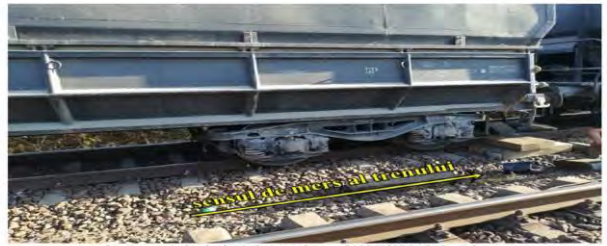
foto 1: poziția boghiului I al vagonului nr. 81536650964-5, după deraiere
