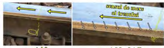
Foto nr.9 - firul exterior al curbei - șina din partea dreaptă a sensului de mers al trenului urma de părisăre a suprafeței de rulare a ciucercii șinei și de cădere a roții între șine
