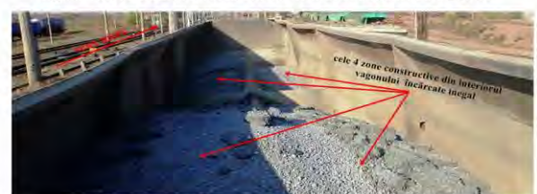
foto 17: aranjarea încărcăturii în vagonul nr.81536650964-5
