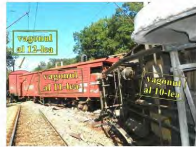
Foto nr.8 – poziția în care se aflau vagoanele care au deraiat
