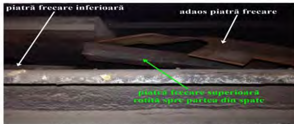
foto 12: pietrele de frecare inferioară și superioară de pe partea stângă a boghiului cu roțile 1+4 în după deraierea vagonului
