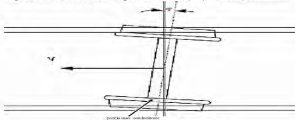
fig. 9. poziția osiei conducătoare în caprinsul curbei
