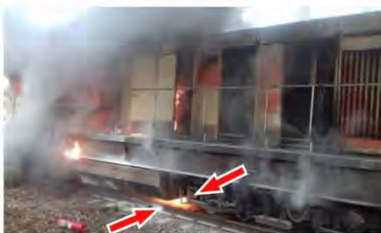
Imaginea 3 - flăcări pe terasament sub rezervorul de motorină (imagini provenite de la martorii oculari)
