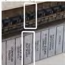
Imaginea 5 - siguranța electrică de la instalația de detectare a incendiilor în compartimentele motor, era nedeclanșată;
